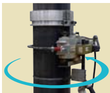
位置や速度を調節するだけ、ぶれずに回りながら溶接します
