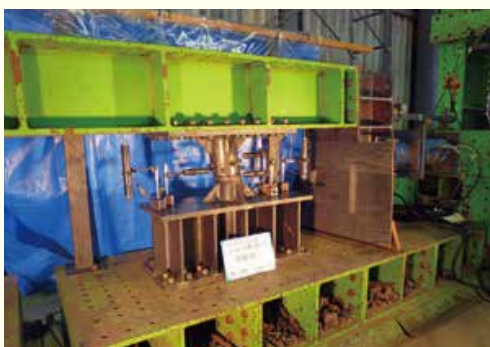
無溶接継手 せん断実験
